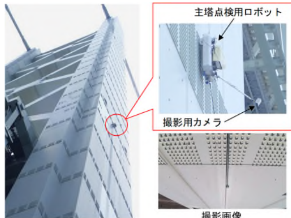
主塔点検用ロボットの検討
