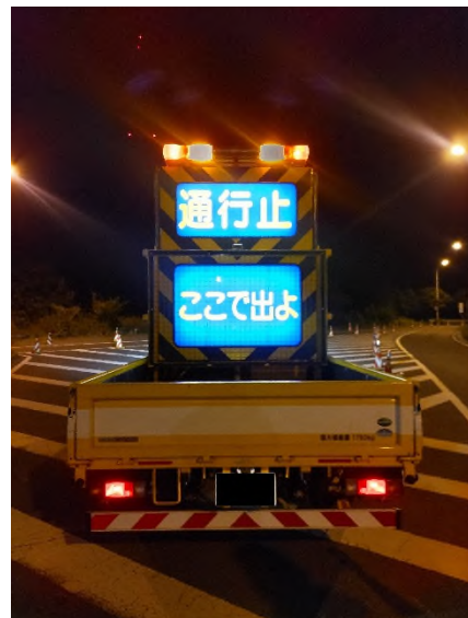
規制車による通行止め状況
