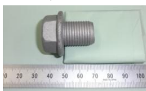
写真-1 TRS(スレッドローリングスクリュー) Photo-1 TRS (Thread Rolling Screw)
