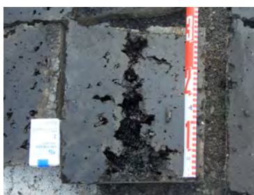
写真-2 グースアスファルト裏面状況 (Photo.2 Bottom of guss asphalt)
