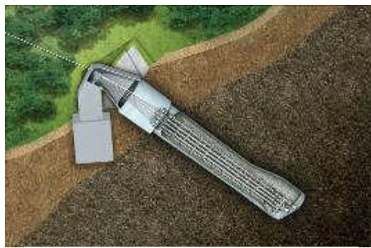
写真 - 8 トンネルアンカレイジ
