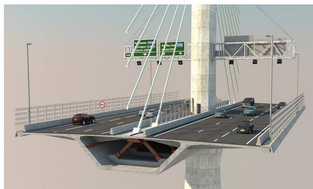
図-2 床版断面図（イメージ） Fig.2 Visualization of Cross Section of Deck
