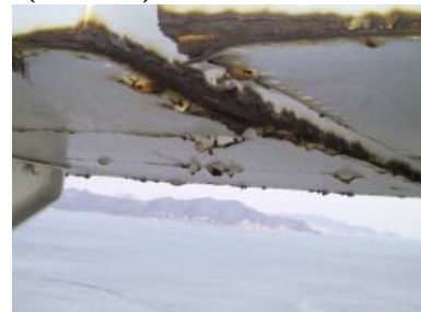
写真-3 ダブルフラップの腐食状況
