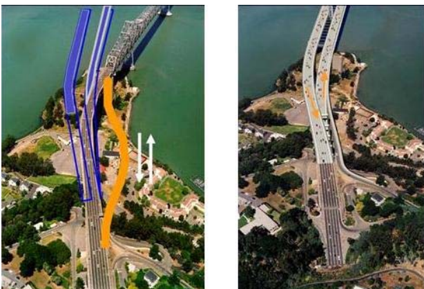
図-5 イェルバブエナ島高架橋の切替計画 Fig.5 Transition Planning to new Yerba Buena Island Va.
