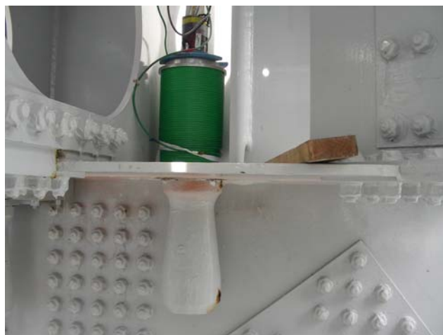
写真-5 全磁束法によるハンガーロープの測定 (Photo.5 The main flux method for suspenders)
