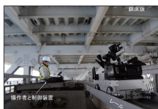
赤外線サーモグラフィによる疲労亀裂検出
