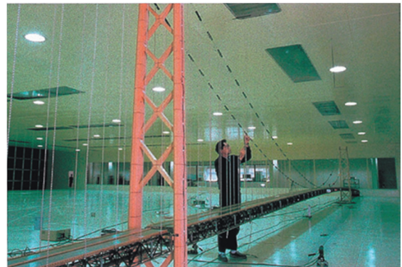
大型風洞試験（明石海峡大橋）
