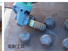
電動工具 素地調整工具の適用性検証
