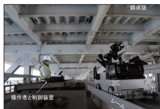
赤外線サーモグラフィによる疲労亀裂検出
