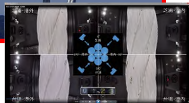
吊橋ハンガーロープ画像点検システム
