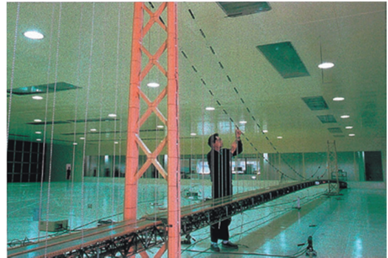
大型風洞試験（明石海峡大橋）
