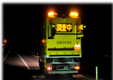
路面性状調査測定状況
