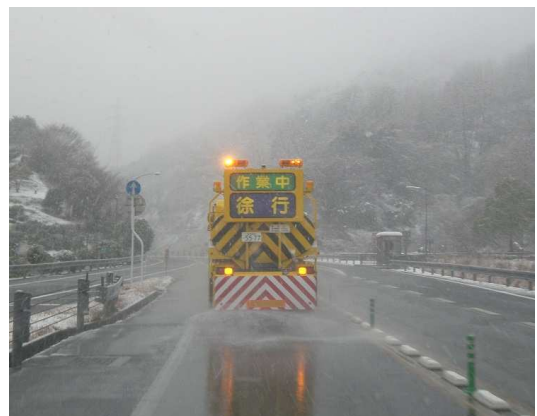
凍結防止剤散布状況
