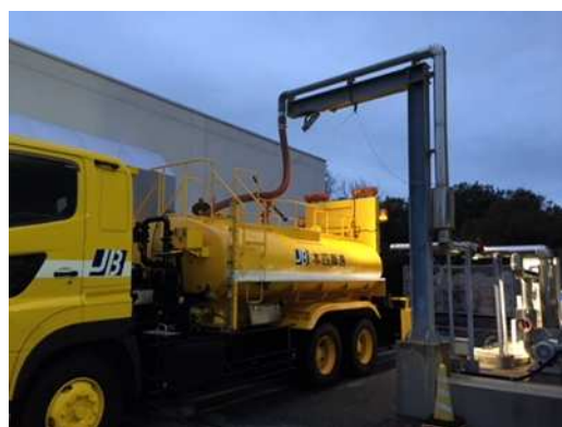
凍結防止剤積込状況
