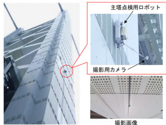
主塔点検用ロボットの検討
