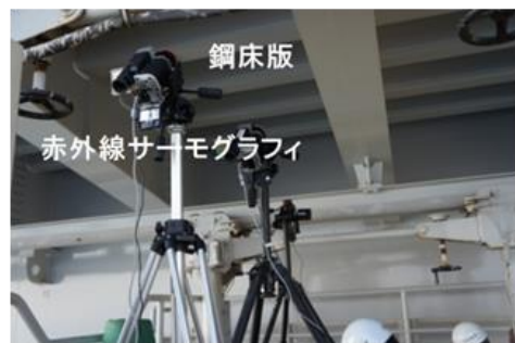
疲労亀裂非破壊検査(温度ギャップ法)
