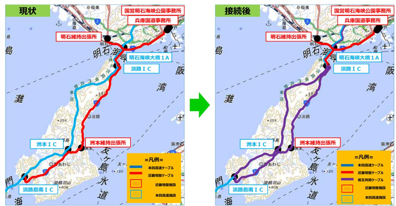
光ファイバケーブルを相互利用することでルート之二重化を図り、災害発生時等において一方が切断されても通信網が途絶えないようにします。（今年度中に接続工事を実施）
