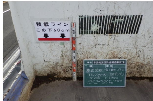
写真－７ 過積載防止：現場発生土
