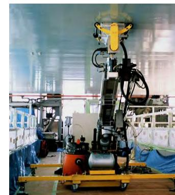
箱桁用塗装装置による塗装
