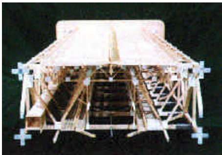
遊歩道を添架した大鳴門橋の風洞試験模型 Wind tunnel test model of Ohnaruto Bridge carrying a promenade
