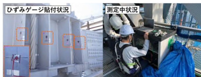
写真-1 ハンガー架替時における実橋測定状況
