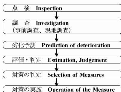
図-1 コンクリート構造物管理フロー
