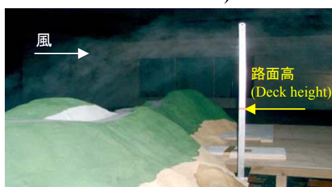
写真-3 岬側からの風況 (Photo.3 Wind condition from cape side)
