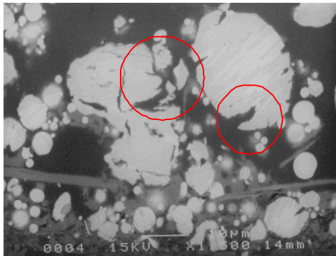
写真-1 酸化した亜鉛粒子の断面顕微鏡写真 (Photo.1 Micrograph of the oxidized zinc particle)
