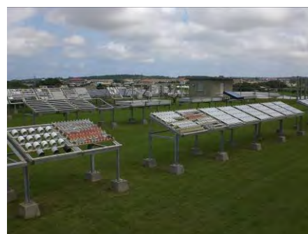
写真-1 宮古島暴露試験 (Photo.1 Paint Exposure Test at Miyako Island)
