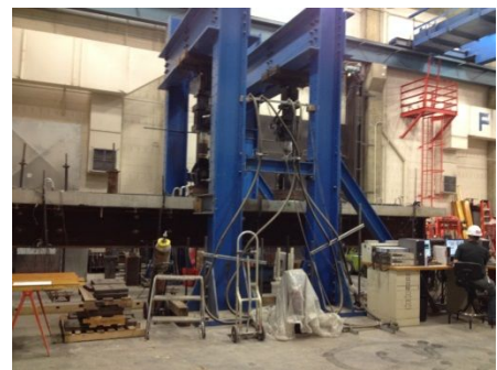
写真-8 プレキャスト床版合成桁の疲労試験
