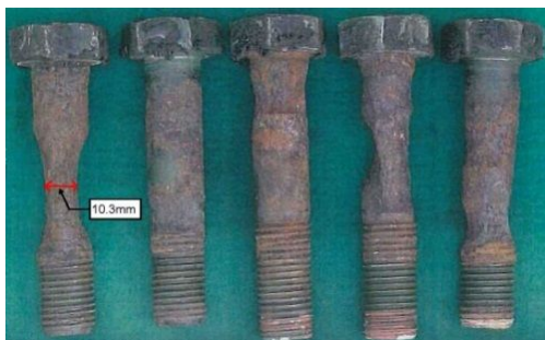
写真-1 ボルトの腐食状況
