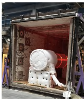
写真-4 ケーブル耐火試験 Photo 4 Fire test in 2018
