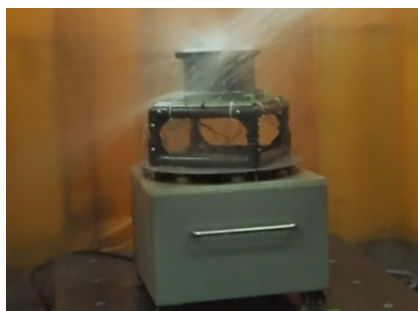
写真-1 密閉性確認試験 Photo-1 Airtightness test
