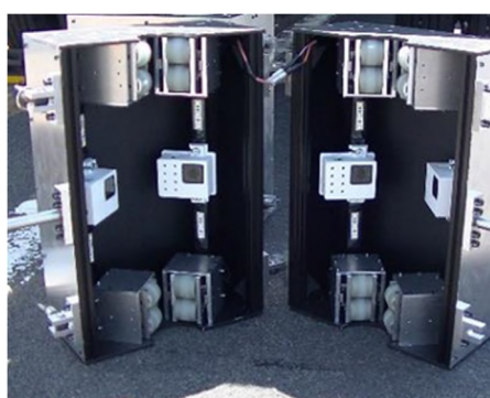
写真-2 カメラ容器(内部) Photo-2 Image acquisition module
