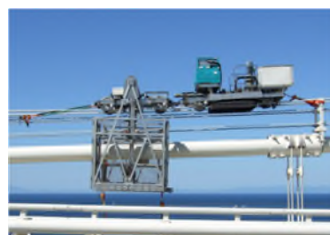
写真-4 ケーブル検査車
