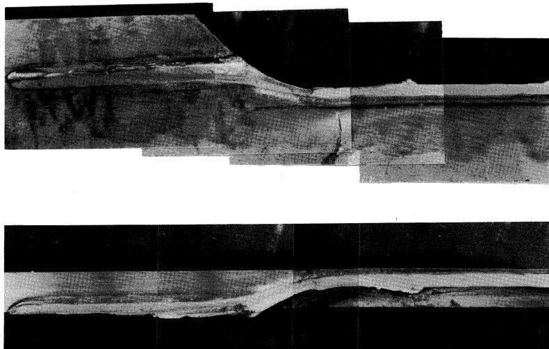
写真-4 遷移部の溶接ビード破面
