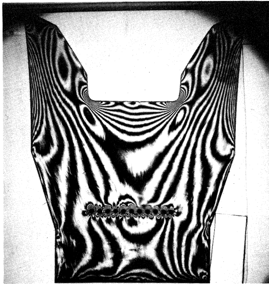
写真-3 光弾性縞写真 (自重+ケーブル張力載荷)
