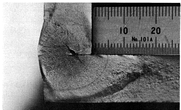
写真-2 ブローホール（1.8×2.5mm）と疲労破面
