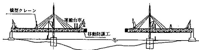
図-3 中央径間の面材張出し架設
