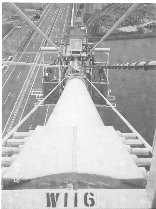
ケーブルバンドボルト軸力測定 (遠景)
