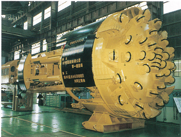
舞子トンネル用のトンネルボーリングマシン (掘削径5m、全長約60m)
