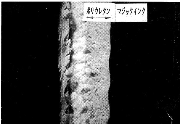
写真-3 Vカット断面拡大状況
