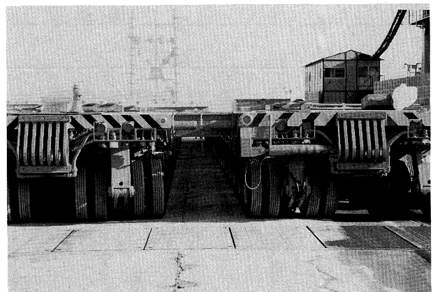
写真-4 ユニットドーリ縦連結部
