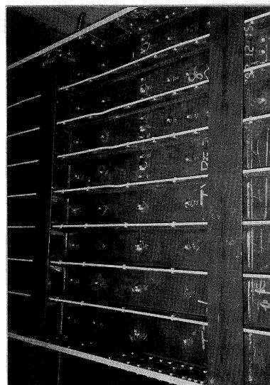
写真-1 終局時の変形状態 (実験結果) Photo.1 Deformation under ultimate state(test)
