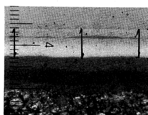
写真-2 光学顕微鏡塗膜厚観察(塗膜断面)
