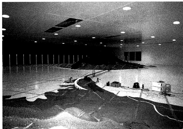
写真 大型風洞での地形模型風洞実験状況 (縮尺1/200)
