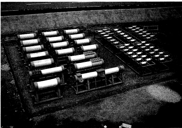
写真-3 小型・大型暴露試験状況
