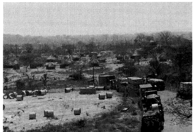
写真-9 ザンビア側で通関待ちのトレーラーの列。ほとんどが重量 40~45 t の 6 軸車。 Photo. 9 A row of trailers waiting passage in Zambia side: almost all are 6-axle vehicles with weight 40 to 50 tons.
