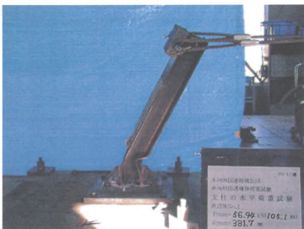
写真-1 支柱の水平荷重試験
