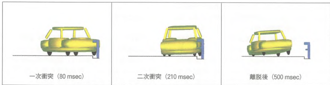
図-9 1 トン乗用車の路側用防護柵への衝突状況 (ケース 2)
