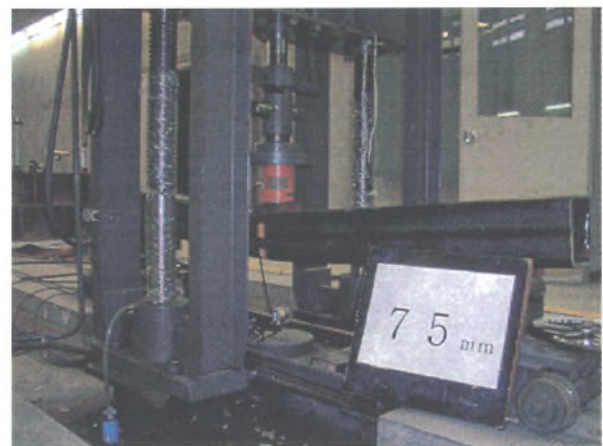
写真-2 横梁の曲げ荷重試験
