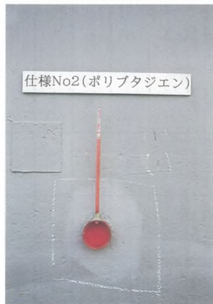
写真-4 透水性測定器の取付け状況
