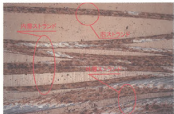
写真-3 赤錆発生箇所拡大写真
