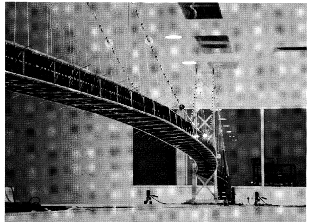
写真-2 明石海峡大橋全橋模型試験
