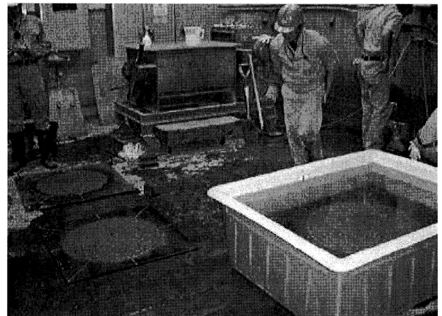
写真-2 スランプフロー試験実施状況
