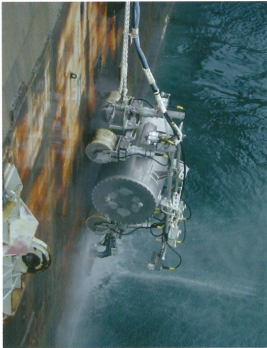
スケール除去装置（電着の施工に先立ち鋼材面に付着した海生生物等を高圧水にて除去する機械） Scale removal device (High-pressure water jet device for removing sea creatures adhering steel surface, used prior to electric corrosion protection)
