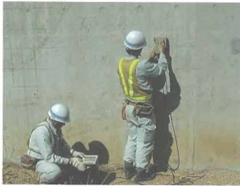
写真-1 電磁波反射法測定
